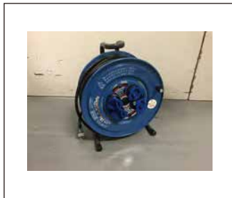
電動ドラム 3台 電線長さ / 30m
